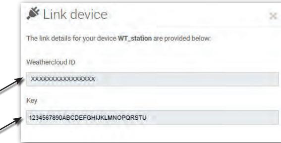
5. Dans l'interface de configuration mentionnée dans **section 8.5**, sélectionnez Weathercloud dans la deuxième ligne de la section de configuration du serveur météo, puis saisissez l'ID et la clé attribués par Weathercloud, et suivez les étapes pour compléter la configuration.
