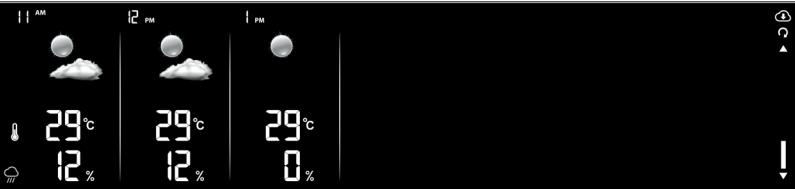
la touche [▼/ HOUR FCST] pendant 2 secondes pour activer la fonction de défilement automatique, et l'icône apparaîtra sur le côté droit de l'écran. La console affichera ensuite les prévisions météo des 24 heures à venir en séquence.
