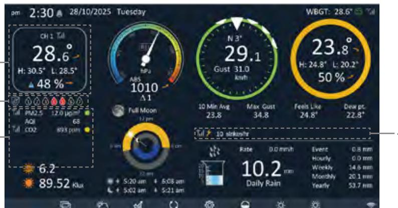
1. Capteur(s) thermo-hygro CH 1~7 : vous pouvez appuyer sur pour basculer entre les lectures de température et d'humidité intérieures des canaux 1 à 7.
